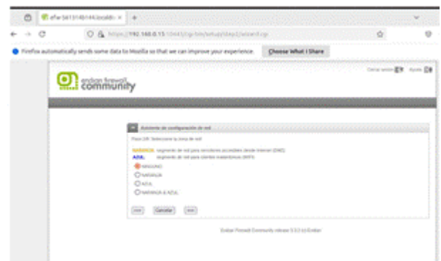
figura 29 Definir la segmentación de red para clientes inalámbricos Fuente: Elaboración Propia – 2025.
