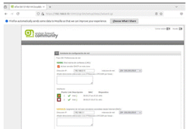
Figura 37 Asistente de configuración inicial para definir los parámetros de red para las zonas verde (LAN) y Naranja (DMZ).
