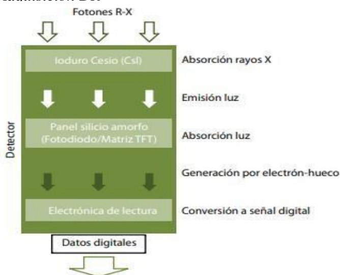
Figura 19. Principio de operación de "flat" panel de silicio.
