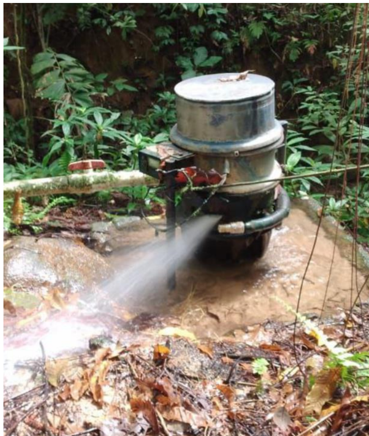
Figura 11. Sistema hidroeléctrico con rueda Pelton
