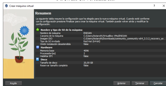
Fig. 1. Resumen de configuración inicial de la máquina virtual Endian Firewall en VirtualBox.
