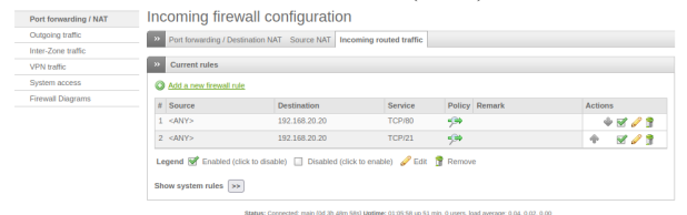
Figura 40. Las conexiones HTTP (TCP/80) y FTP (TCP/21) en el tráfico entrante desde la ZONA ROJA (WAN) hacia la ZONA NARANJA (DMZ).
