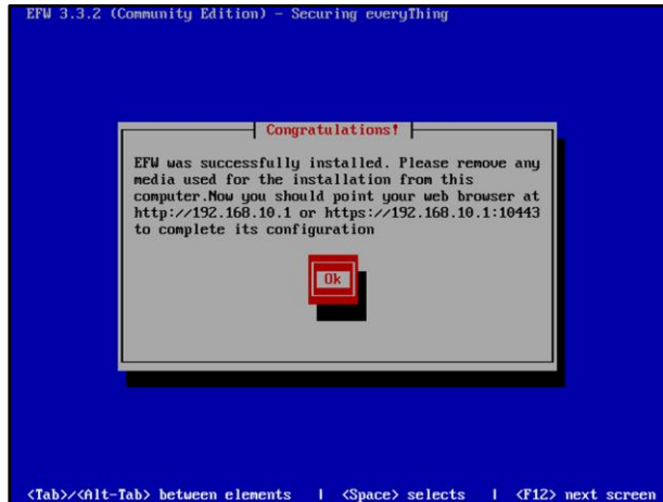
Figura 9. Notificación de finalización de instalación y parámetros de acceso web
