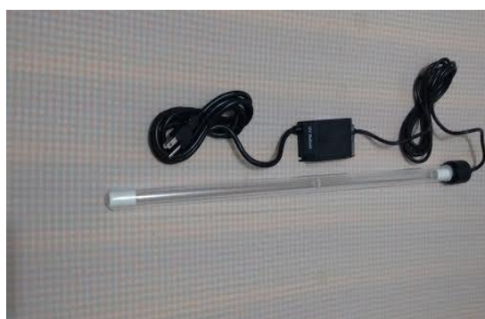
Figura 7. Lámpara sumergible UV tipo C de 30 W utilizada en el proyecto, capacitada para tratar 1500 litros de agua
