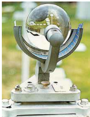
Figura 6. Solarímetro Campbell-Stokes, mide la insolación ( Wh/m^2 ).
