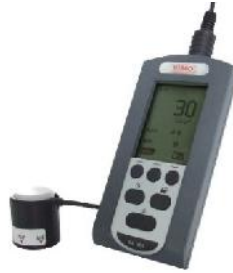
Figura 5. Piranómetro común, mide la irradiancia en un lugar ( W/m^2 ).
