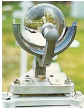
Figura 6. Solarímetro Campbell-Stokes, mide la insolación ( Wh/m^2 ).
