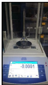
a) Balanza analítica con picnómetro vacío
