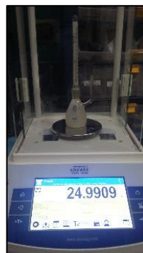
b) Balanza analítica con picnómetro lleno (yuca)
