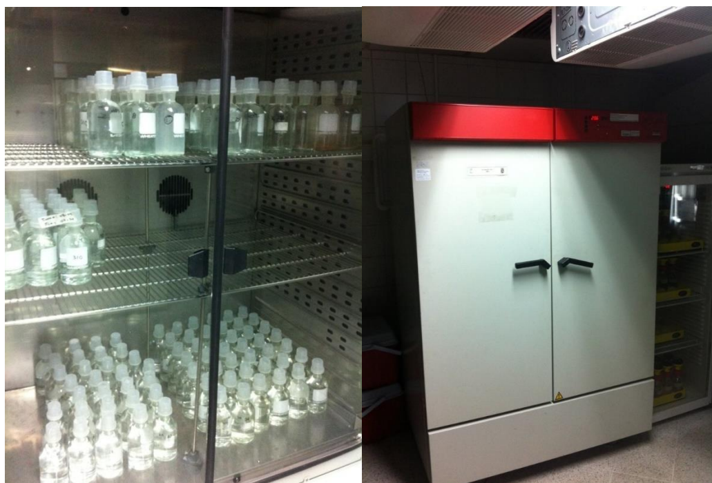
Foto 3. Incubación de muestras de \text{DBO}_5 en la oscuridad a 20^\circ\text{C} .
