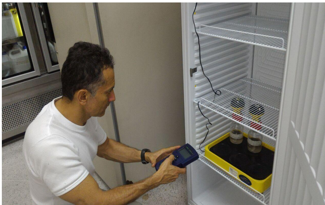
Foto 5. Lectura de DBO_{32} por Respirimetria con el control del Oxitop.
