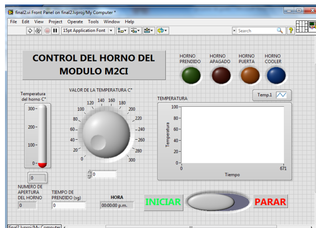
Figura 79. Programación de VI para control del horno
