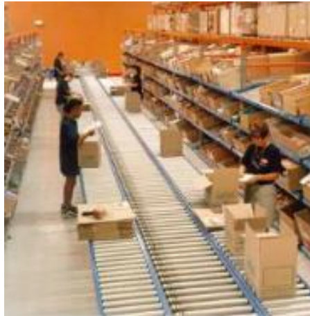
Figura 27. Preparación de los pedidos a través de bandas transportadoras
