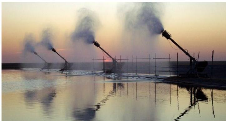
**Figura 5** Evaporadores mecánicos para la industria del petróleo
