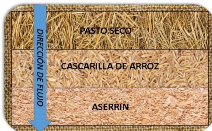
**Figura 9** Diseño del Filtro
