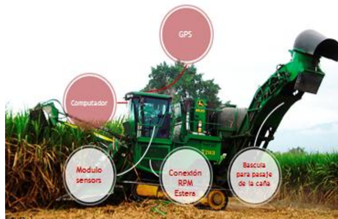
Figura 3. Sistema de precisión integrada en la cosechadora de caña Fuente: (Garcia Jimenez, 2017)
