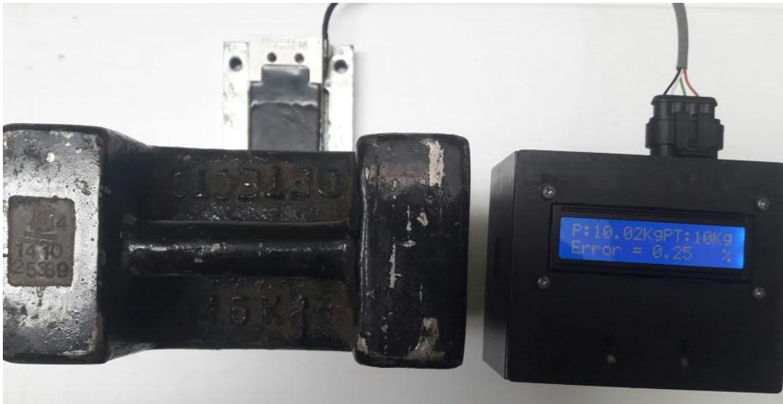
Figura 9. Prueba de la herramienta de diagnóstico y calibración de celdas de carga
