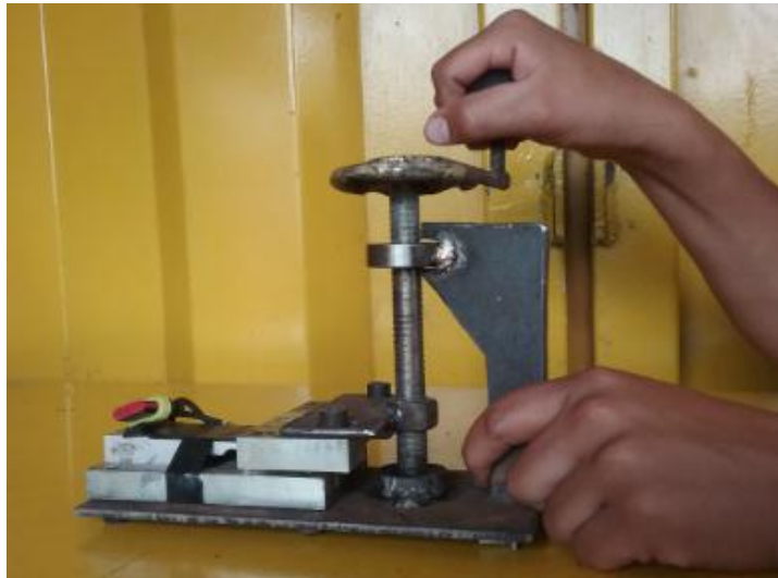
Figura 10. Celda de carga con la herramienta de calibración.
