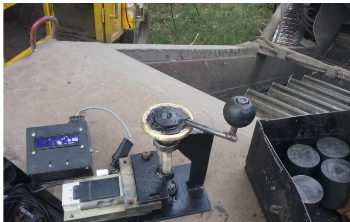
Figura 11. Calibración y ajuste de las celdas de carga en el proceso de pesaje.
