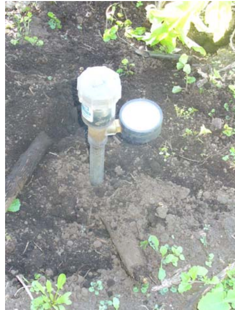
FOTO 4. Tensiómetro para monitoreo de humedad en el suelo.
