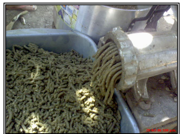
paletizado en molino de disco
