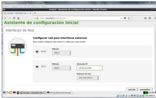
Figura 40. Configuración de interfaces de red.
