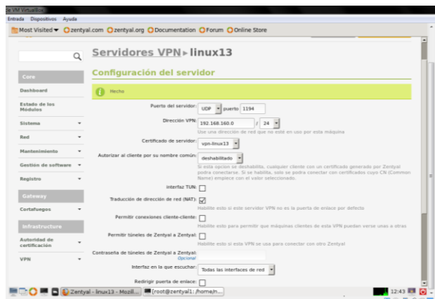
Figura 136. Configuración de VPN servidor
