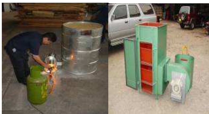
Ilustración 15: Secadora de tres mallas a gas propano Fuente: Comité Departamental de Cafeteros de Caldas
