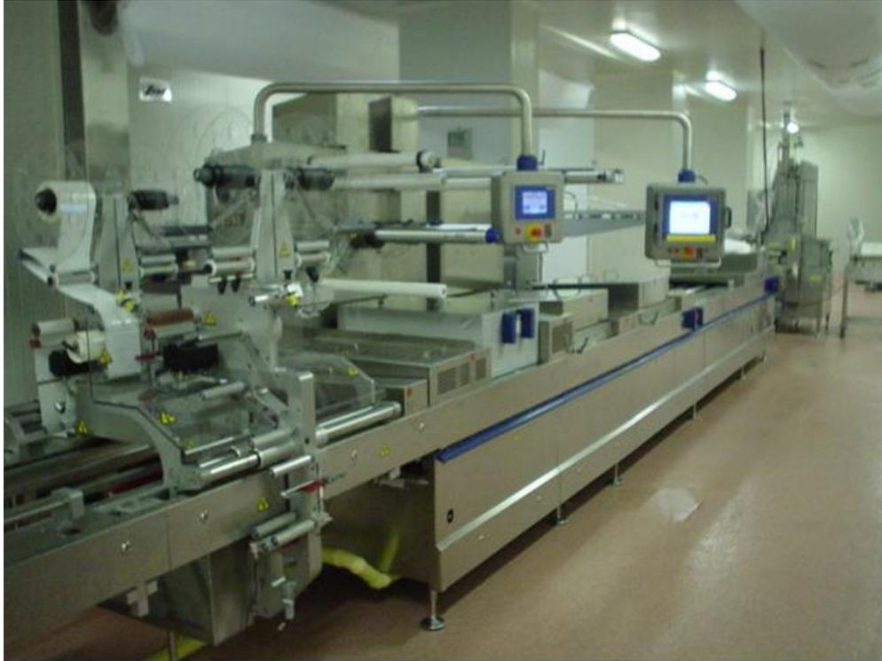
**Figura 8 Empacadora termoformadora MULTIVAC Modelo R250**
