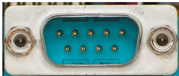
Figura 35. Conector serie RS-232 de 9 pines
