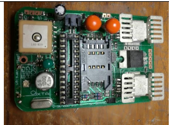
Figura 66 Fase 4, soldadura de los componentes
