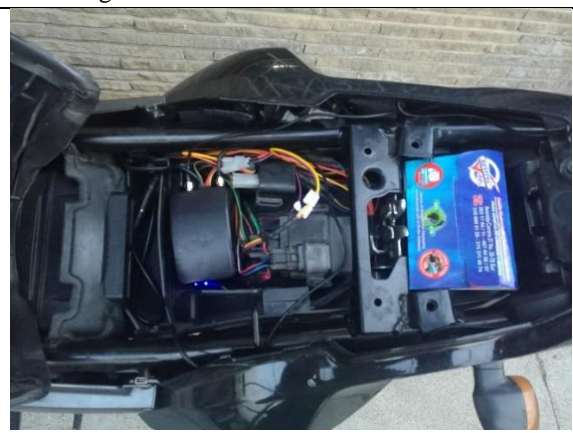
Figura 78 Montaje del módulo alarma en la motocicleta 3, las antenas son ubicadas en la parte trasera
