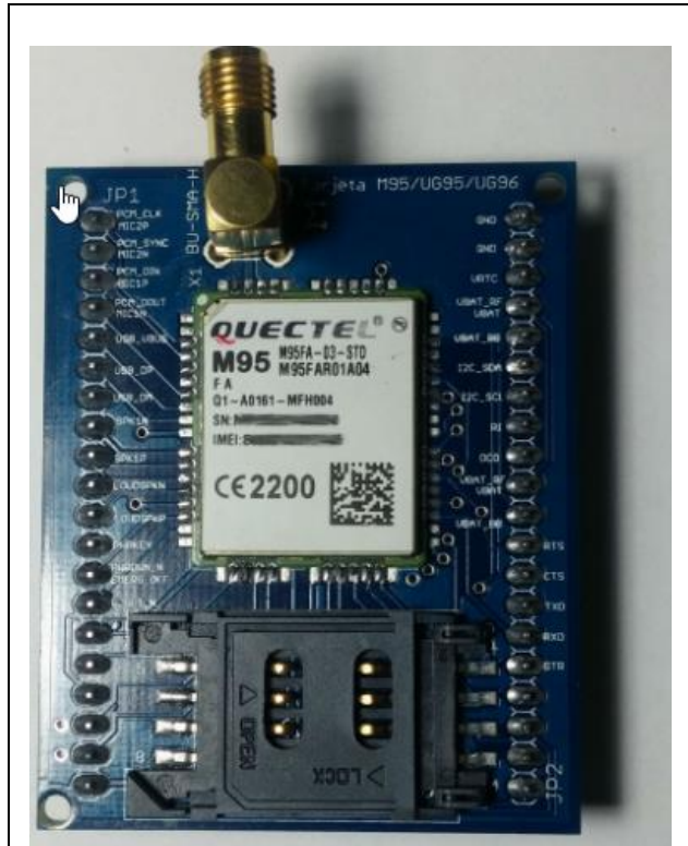
Figura 46 Tarjeta de pruebas M95. Electrónica (2014).
