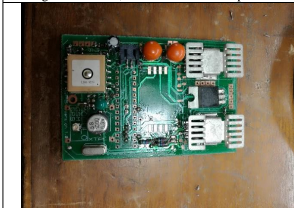
Figura 65 Fase 3, soldadura de los componentes
