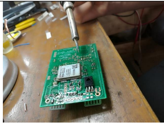
Figura 64 Fase 2, soldadura de los componentes
