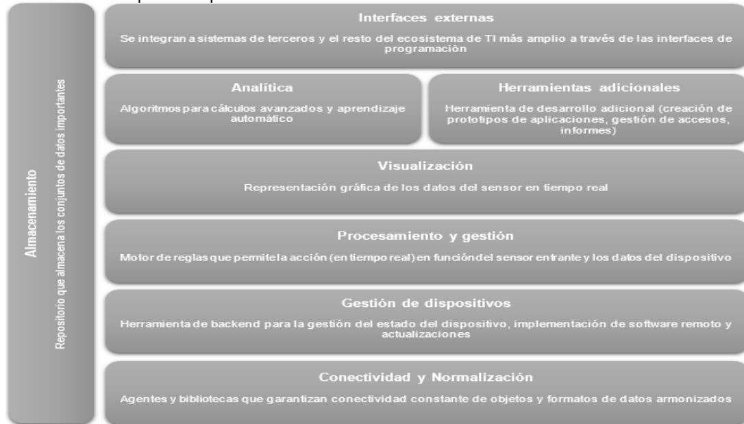
Ilustración 35. Componentes plataforma IoT
