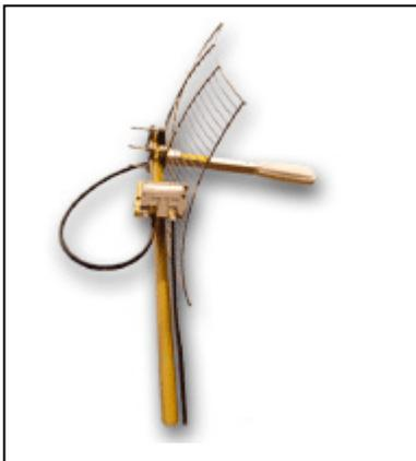
El tipo de Antena que se está utilizando es grilla figura 33. Este tipo de antena soporta distancias hasta de 20 Km, cuenta con un Edipolo Feeder por la que llega la señal, tiene un amplificador de señal que se usa para dar más potencia y más seguridad a la transmisión de los datos.
