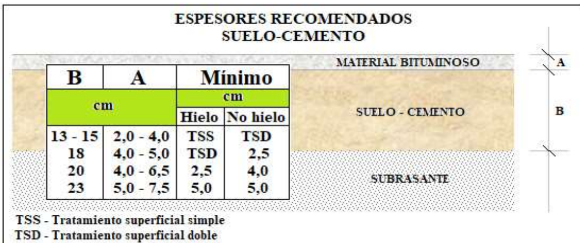
Figura 11. Espesores de Suelo – cemento recomendados, sin ajuste y capas asfálticas.
