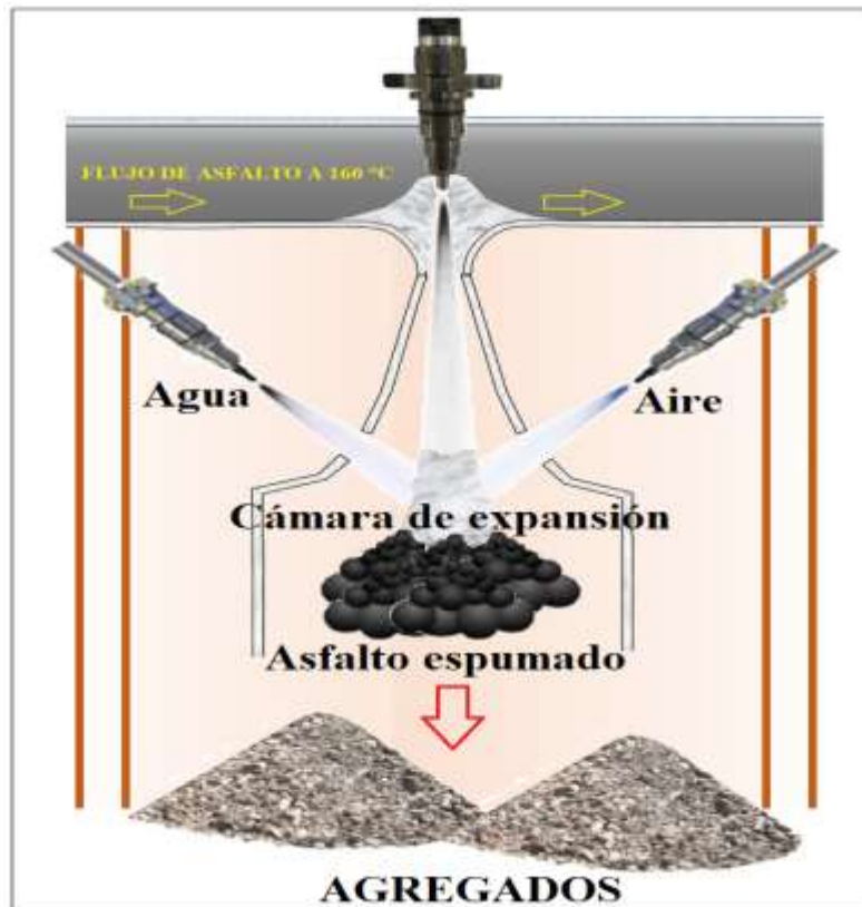
Figura 13. Mecanismo del principio del asfalto espumado.
