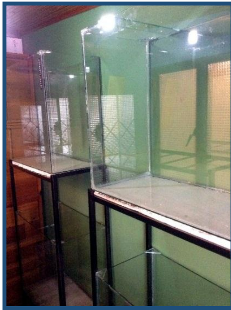
Ilustración 30. Acuarios montados en bases de hierro con base de icopor.
