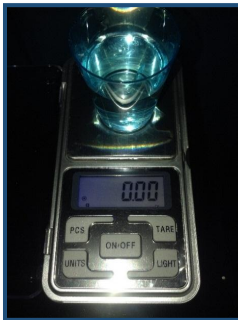
Ilustración 42. Gramera digital con recipiente con pesaje en ceros. Fuente: (Cuchia, 2018)
