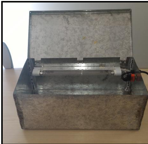
Figura 6: Caja metálica piloto para el ensayo de radiación con Luz Ultravioleta. Fuente: Propia.
