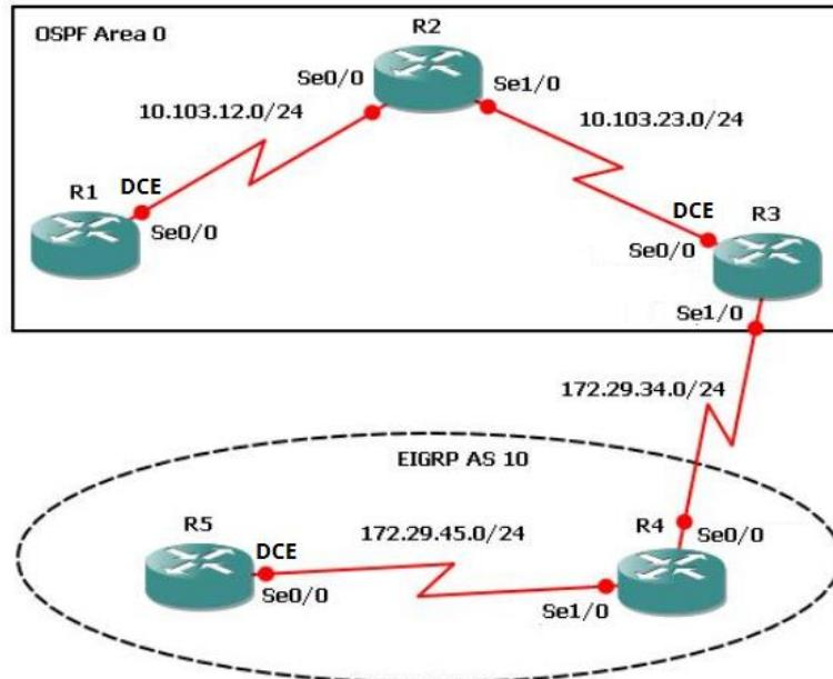
1. Aplique las configuraciones iniciales y los protocolos de enrutamiento para los routers R1, R2, R3, R4 y R5 según el diagrama. No asigne passwords en los routers. Configurar las interfaces con las direcciones que se muestran en la topología de red.
