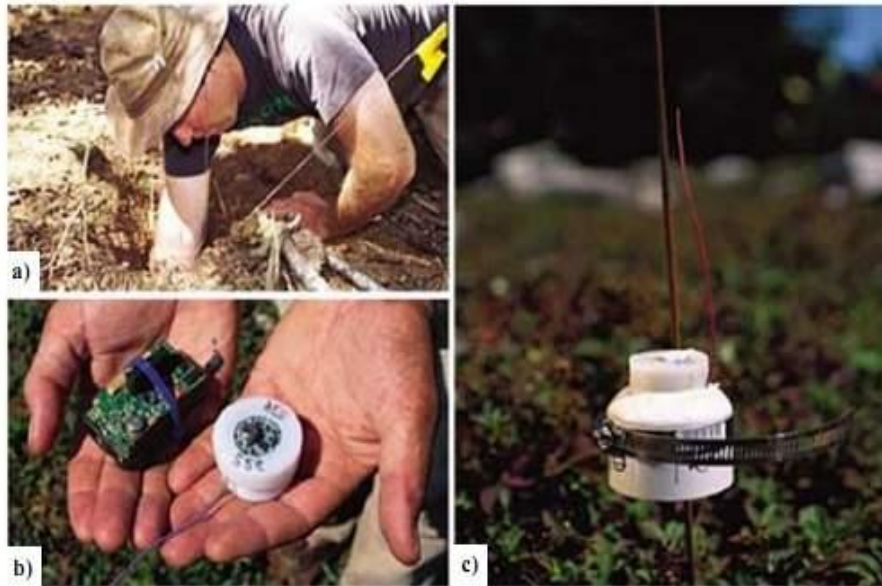
Figura 9. Instalación de los nodos sensores en la isla Great Duck
