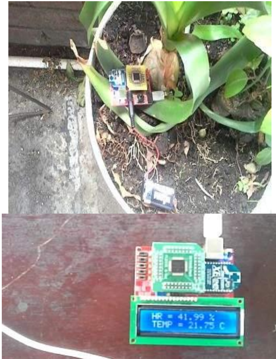
Figura 91. Planta 1 y de la prueba resultados visualizados en la LCD.
