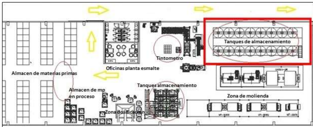
Imagen 35. Layout Planta Esmaltes
