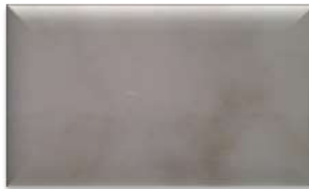
Imagen 22. Defecto por incrustación de engobe
