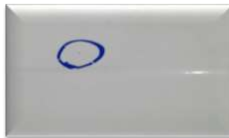
Imagen 19. Defecto por punto metálico
