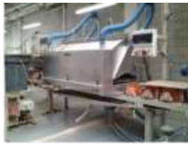
Cabina Airless para aplicación de engobe
