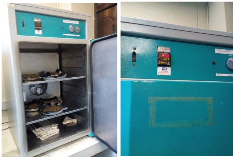
Figura 5. Secado en horno de aire forzado a 60°C
