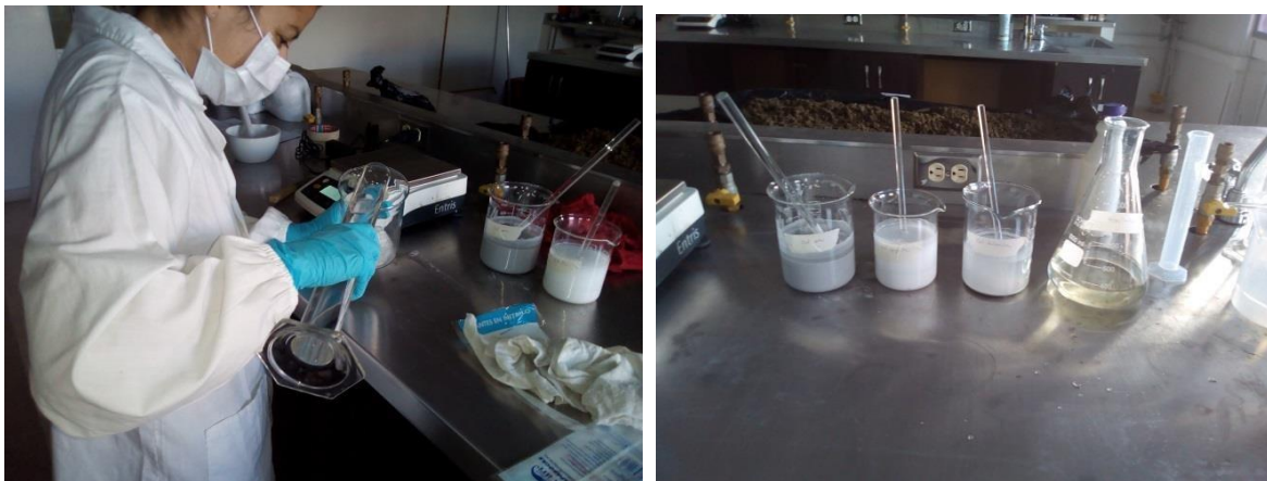
Figura 4. Aplicación de tratamiento químico (cal dolomita, cal apagada, hipoclorito de sodio 15%)
