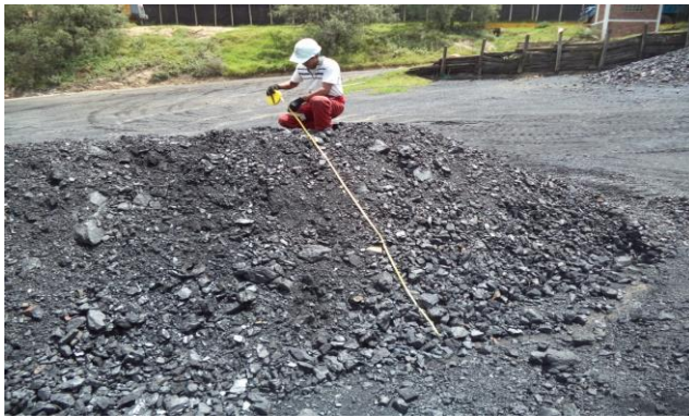
Fotografía No 9 Verificación de alturas en pilas de carbón
