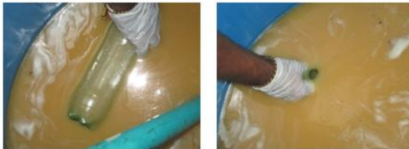
Foto N°14: Extracción de la muestra del lixiviado.
