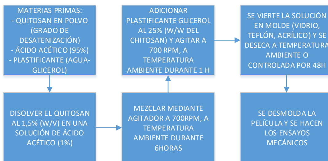
Figura 8: Proceso para la obtención de películas de quitosano
