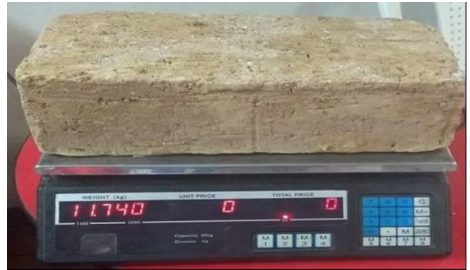
Vista del secado del Adobe 2ª semana y peso de la pieza
