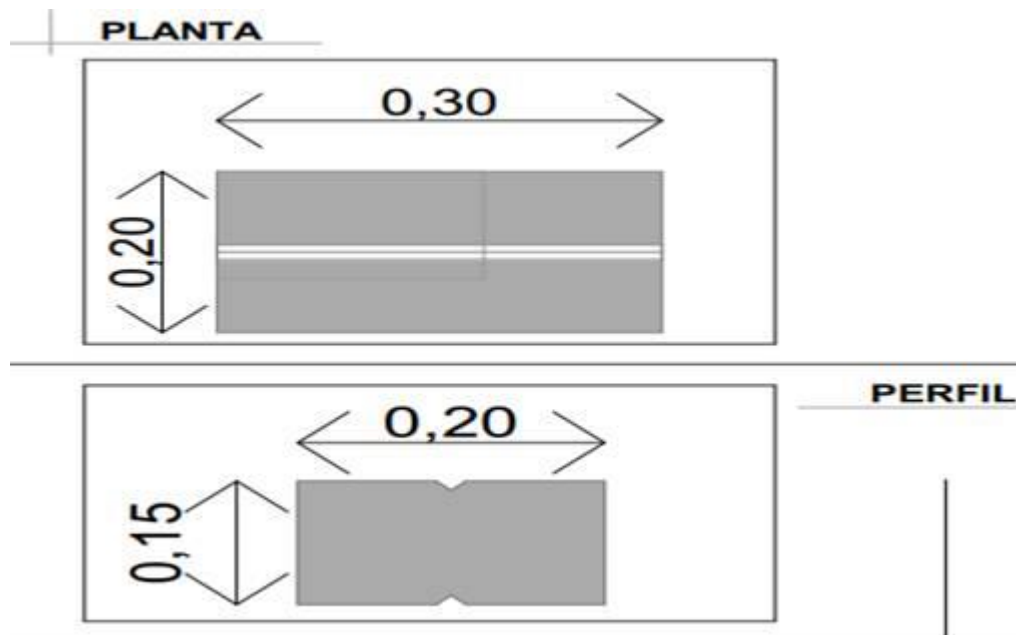
Pieza de adobe vista general con dimensiones en cm. ( imagen 4 )
