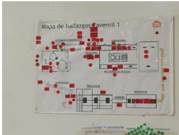
Figura 8. Mapeo y localización de hallazgos en las líneas de producción
