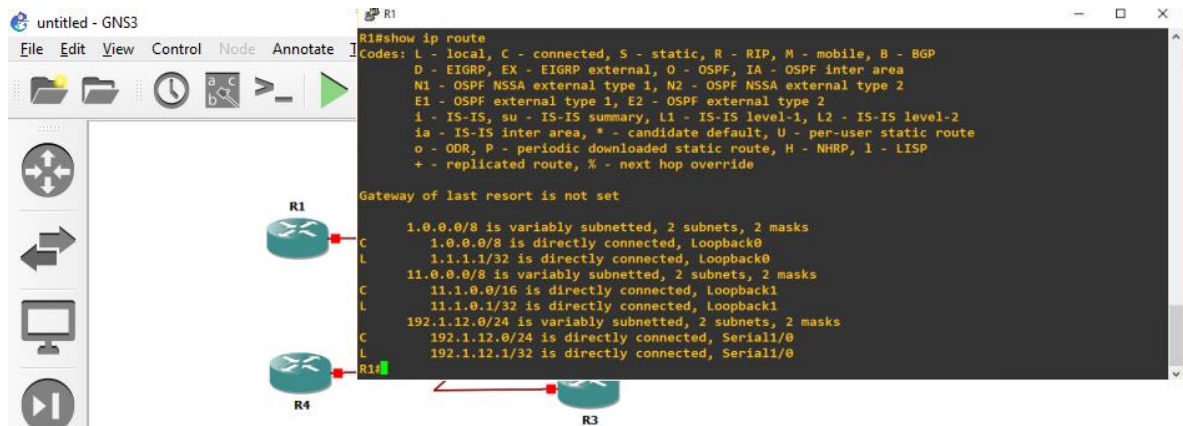
Figura 9. Simulación y configuración de R1
