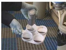
**Paso 3:** Rote la raqueta con movimientos circulares hasta mezclar totalmente el contenido. No lo mezcle por más de 10 segundos.
