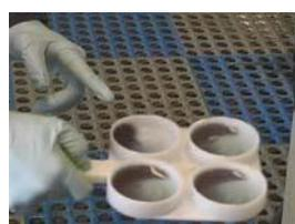
**Paso 4:** “Lea” rápidamente la prueba. La reacción visible desaparece en unos 20 segundos. La reacción recibe una calificación visual. Entre más gel se forme, mayor es la calificación.
