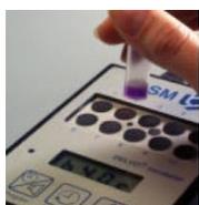
Después del tiempo requerido de incubación, lea el resultado en los 2/3 inferiores del agar sólido contenido en el tubo.
