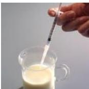
Vacíe lentamente el contenido de la jeringa en el tubo correspondientemente marcado. Use una punta estéril por cada muestra.
