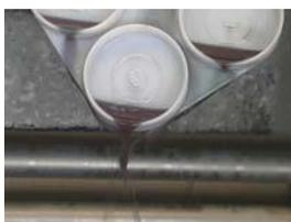
**3 + = Positivo Fuerte (*Infectado*).** Hay formación de gel y la superficie de la mezcla se eleva (como un huevo frito). Esta elevación central permanece aún después de detener el movimiento de rotación de la raqueta de CMT.
