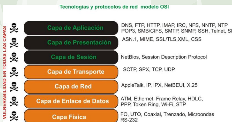
Figura No. 1. Modelo OSI. Fuente: Ing. Carlos Alberto Amaya Tarazona. 2013. Duitama. Seguridad en aplicaciones Web. Universidad Nacional Abierta y a Distancia
