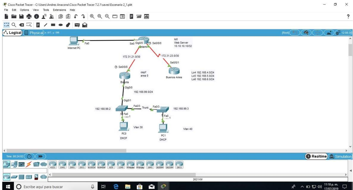
En la anterior grafica se analiza que todos los puntos interconectan de manera correcta porque los puntos en las conexiones son de color verde, además de unas pruebas de ping que fueron satisfactorias.
