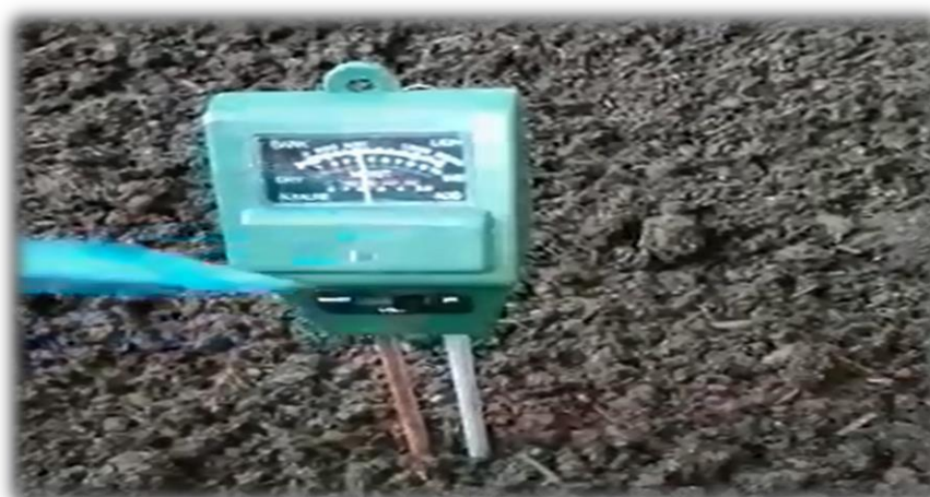
Figura 17. Prueba con tester de PH
