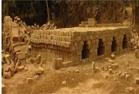
Figura 3 horno intermitente de cámaras individuales
