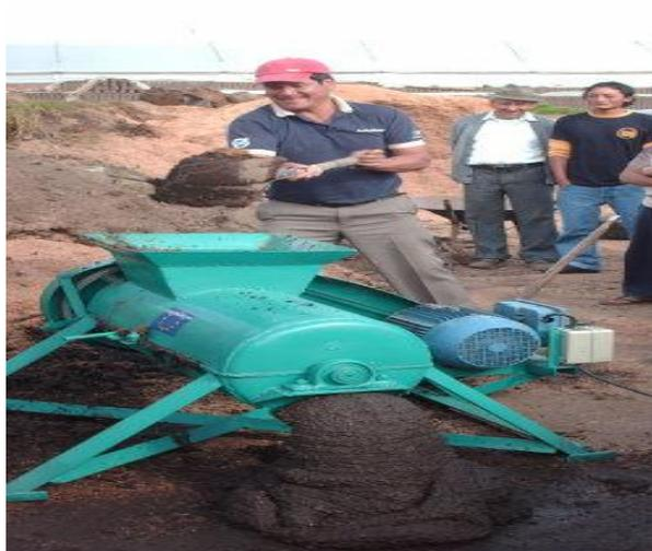
Figura 7. Molino mezclador con motor
