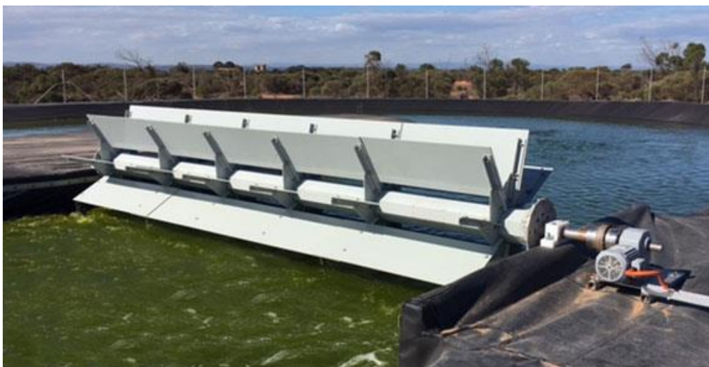
Imagen 1. Sistema de cultivo abierto tipo Raceway. Fuente: (AlgaeIndustryMagazine.com, 2017)
