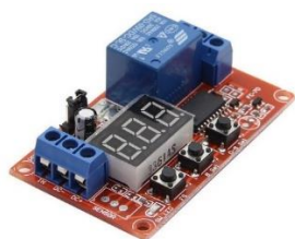
Figura 6: Modulo con relé de 5V, 18 modos de operación, Autor: (Didacticas Electronicas, 2019)
