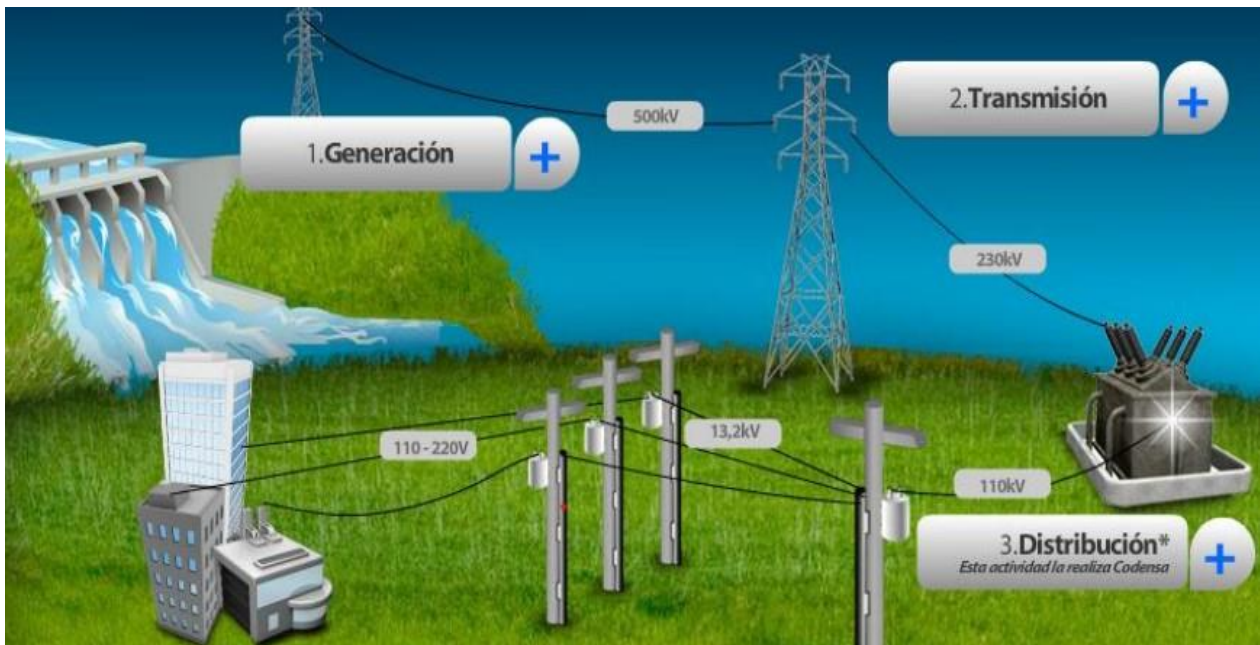
Grafico 1. Cadena Productiva de la Energía Eléctrica. Codensa S.A. E. S. P.
