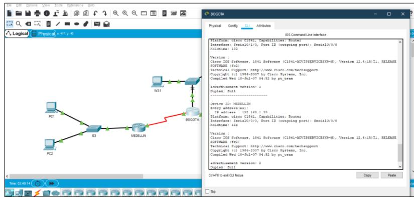
e. Realizar una prueba de conectividad en cada tramo de la ruta usando Ping.
