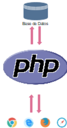
Ilustración 2 Interacción php, base de datos y navegadores
