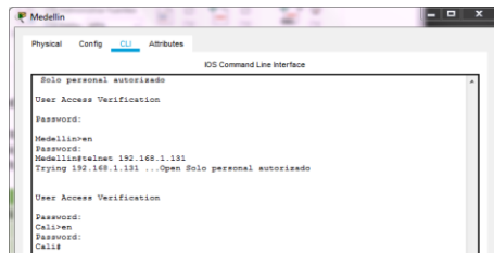
Ilustración 22 - Router Medelin a Router Cali
