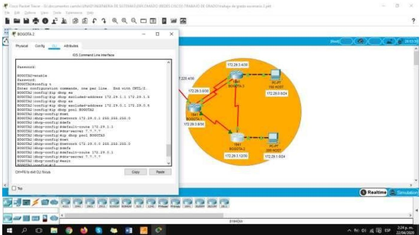
d. Configure el router Bogotá3 para que habilite el paso de los mensajes Broadcast hacia la IP del router Bogotá2.
