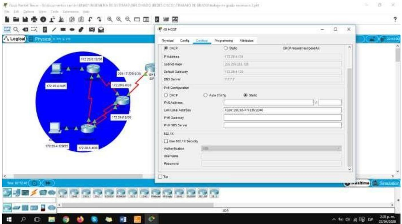
c. Configurar la red Bogotá2 y Bogotá3 donde el router Bogotá2 debe ser el servidor DHCP para ambas redes Lan.
